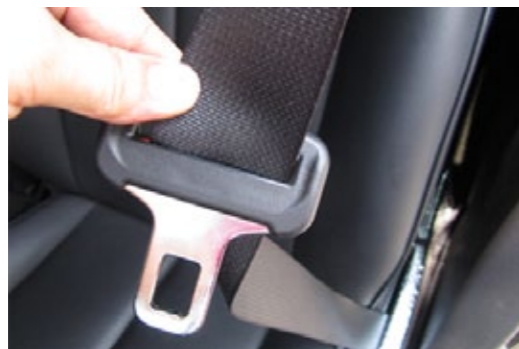
確認安全帶各部件是否有破損
