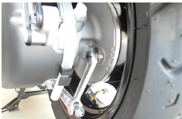
▲ 鼓式煞車示意圖。
