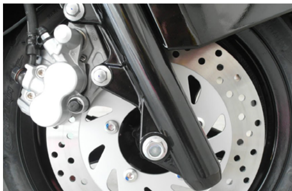
▲ 碟式煞車示意圖。
