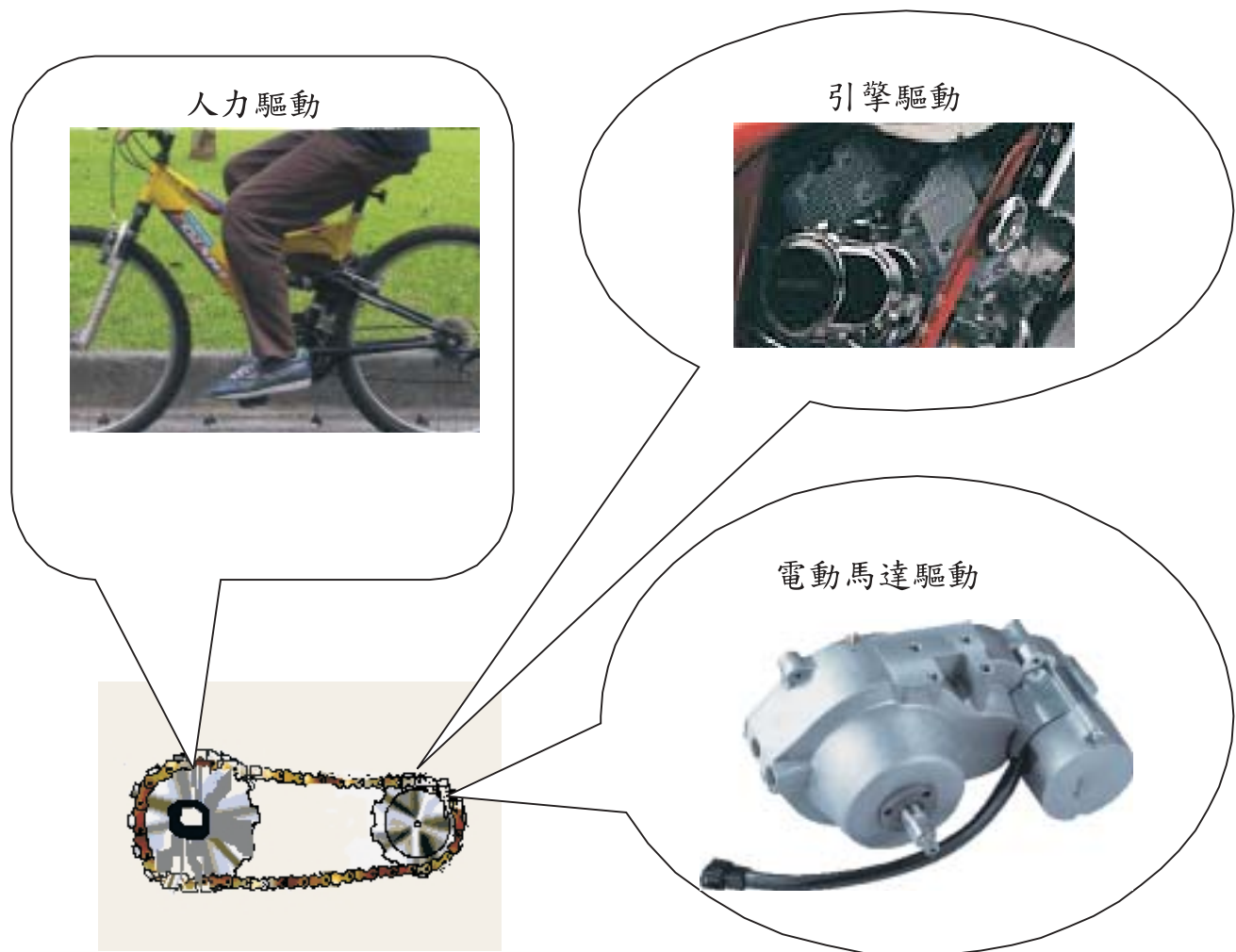
圖5-11 傳動系統之動力來源
