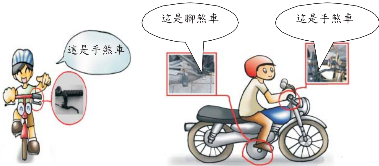
圖 5-3 二輪車之煞車
