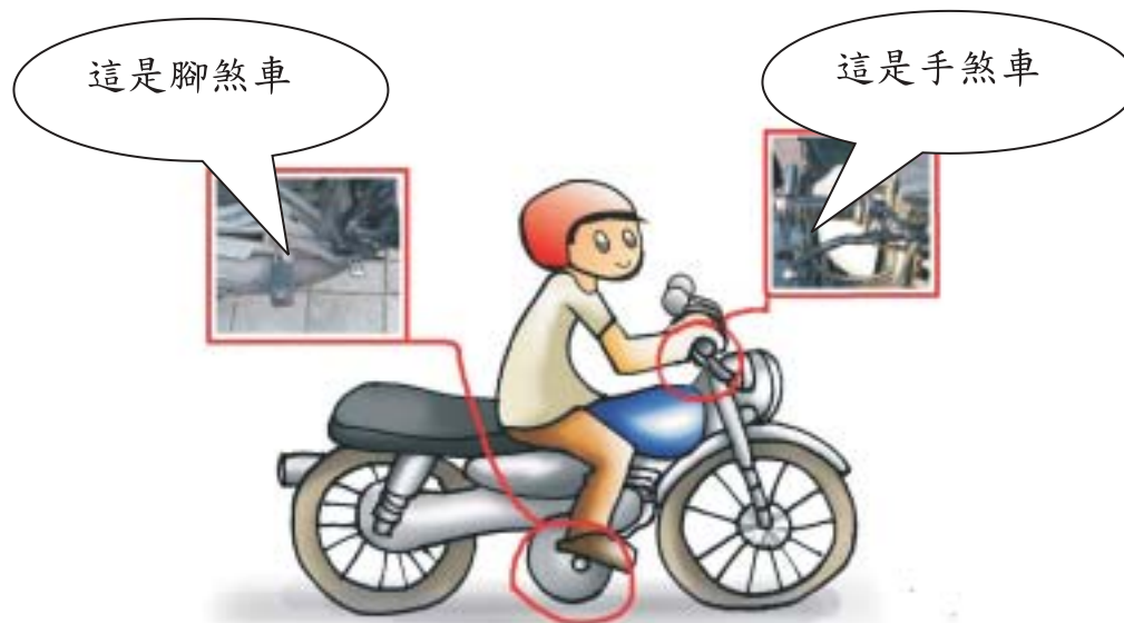
圖 5-13 機車的煞車裝置
